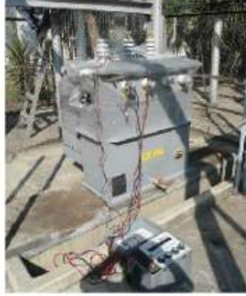
Prueba de resistencia ohmica.
